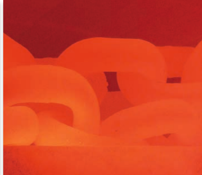
Wärmebehandlung von Rundstahlketten
