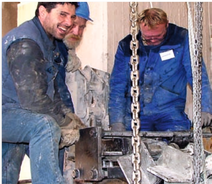
Kettenmesslehre zur Überprüfung der Kettenlänge
