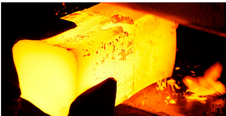
Als Ausgangsmaterial können quadratische Knüppel (Seitenlängen von 50 mm bis 120 mm) oder Rundmaterial (18,5 mm bis 200 mm Durchmesser) verwendet werden.
