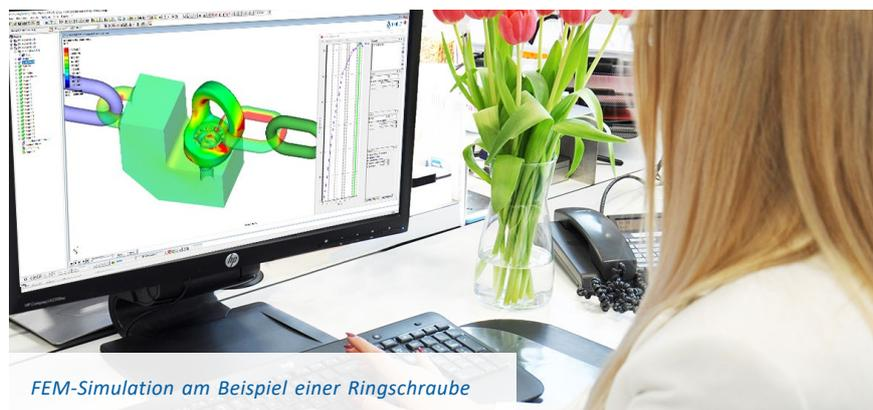
FEM-Simulation am Beispiel einer Ringschraube
